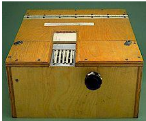
Fotos de dos ejemplares de máquinas de enseñanza donde el alumno puede escribir la respuesta en un lateral, y hacer avanzar los siguientes ítems o tareas programadas.
